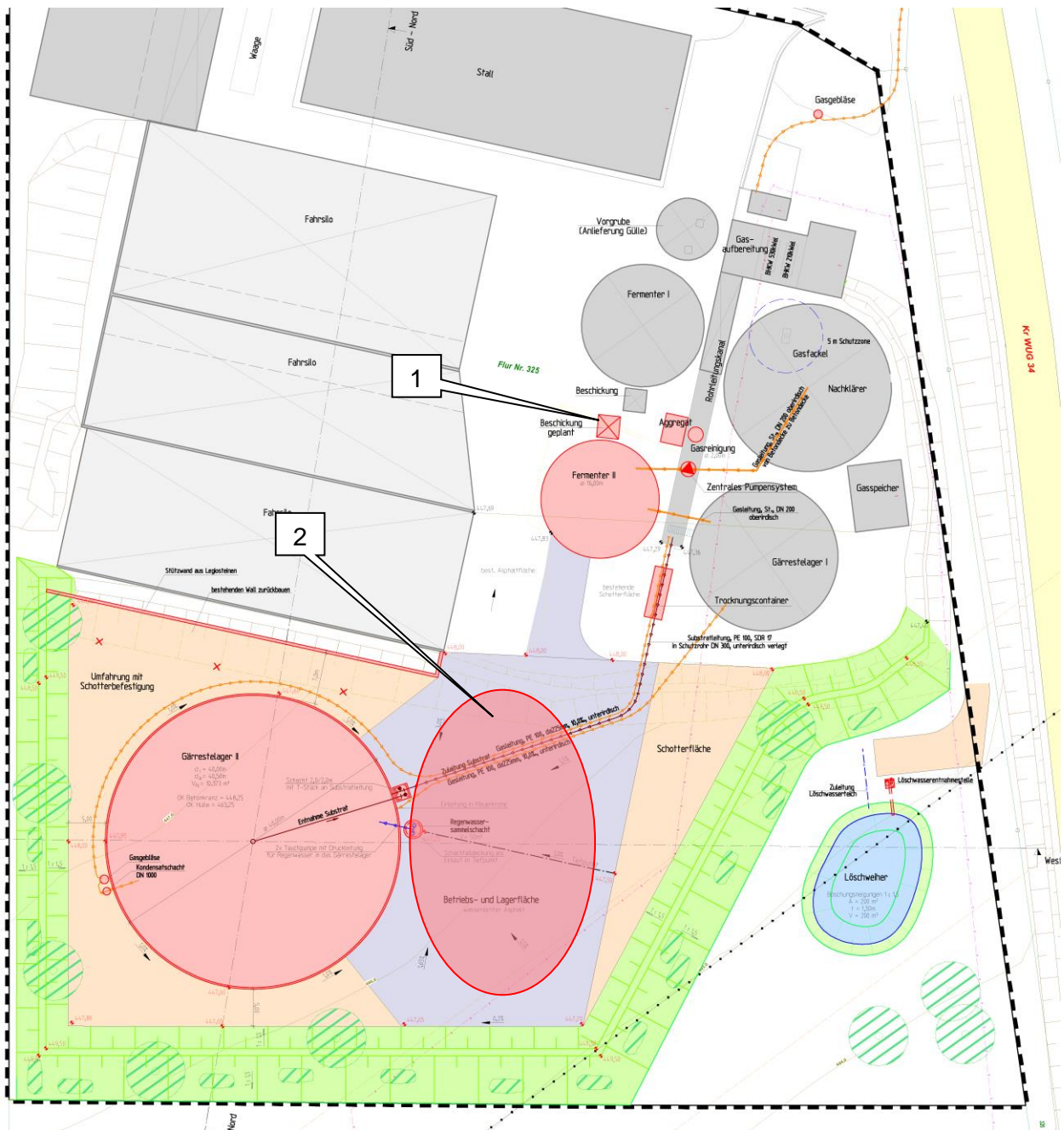
Abbildung 3: Geplante Erweiterung der Biogasanlage 3 (rot markiert)
